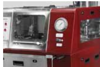
시료 주입부를 제외한 배관 라인에 외부 케이스를 설치하여 안전성 확보
