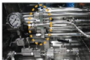
延长内部密封件的寿命，在高压发生部位设置冷却装置减小对设备的损伤
