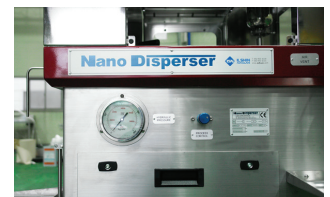
유압 유닛을 이용하여 챔버(Chamber) 내 압력 조정
