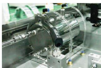
处理后排出的管道安装冷却机，为通过管道后发生的热防止试料的损坏
