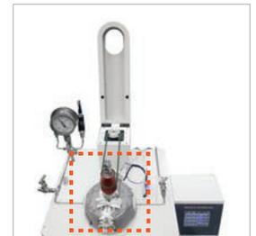
在盖子上安装隔热套或热线套提高热效率并可提高温度精确度。
