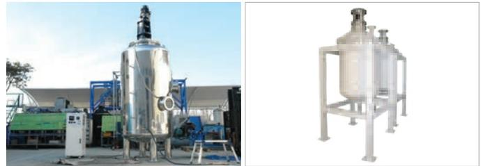
外压测试用大型压力容器
