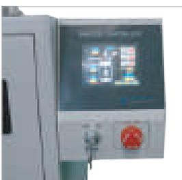
安装触摸屏方便操作，并可以进行USB数据提取。此外，根据客户的要求，可以与PC连接
