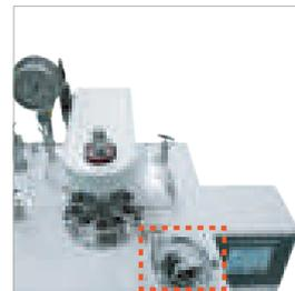
反应器的主体可用螺纹杆手动方法可以上下移动
