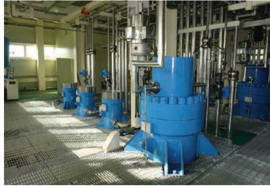
超临界二氧化碳萃取设备 Supercritical CO<sub>2</sub> extraction system
