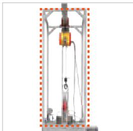
用电动升降机把反应器的盖子和搅拌机上下移动打开，只盖子重时使用。
