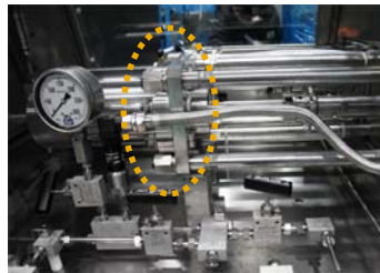
반응기 내부로 유체를 공급하여 압력을 발생시키며, Air로 구동됩니다. 반응기의 용량 및 압력에 따라 펌프의 수량 및 사양을 선정하여 설치합니다.
