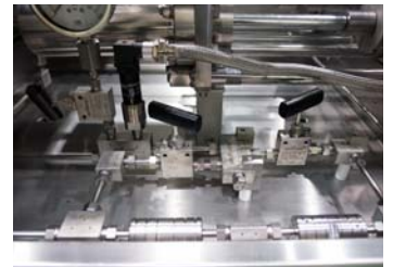
시료 장입을 편리하게 하기 위해 PIN /YOKE 타입으로 제작하며, 유압을 이용하여 자동으로 동작합니다. 반응기 내부 시편을 쉽게 넣을 수 있는 트레이 등은 추가사항으로 제작 가능 합니다.
