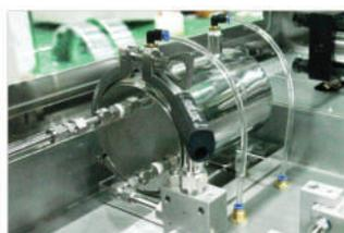
공정 후 배출되는 배관에 냉각 장치를 설치, 챔버(Chamber) 통과 후 발생하는 열로 인한 시료의 손상 방지
