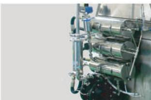
비가동시 원료의 고형화 방지를 위한 용액(Solution) 저장 탱크 및 자동밸브 장착
