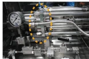
내부 씰(Seal) 수명을 위해 고압 발생 부분에 냉각라인을 설치하여 마찰열에 의한 손상 최소화
