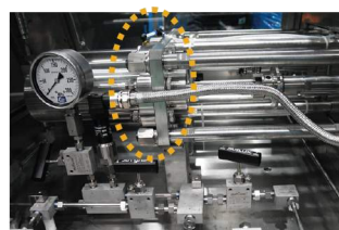
내부 씰(Seal) 수명을 위해 증압기 부분에 냉각라인을 설치하여 마찰열에 의한 손상을 최소화
