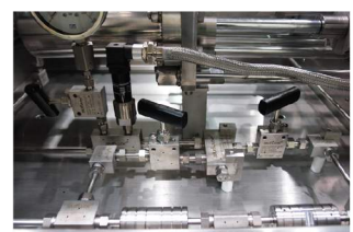
Back Flushing System으로 챔버(Chamber)의 막힘현상발생시 편리한 세척 가능
